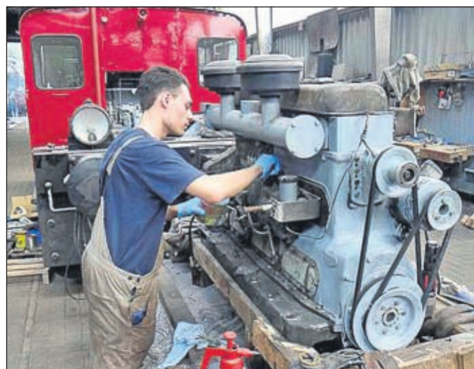
Juni 2016: Die Arbeiten gehen weiter, wenn auch vorerst nur mit etwas Farbe für den Motor, der zwischenzeitlich schon mit neuen Keilriemen versehen worden ist.
