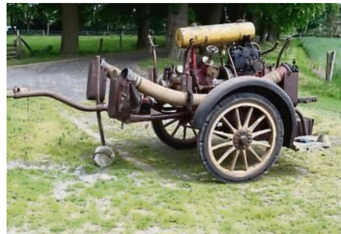
Der Tragkraftspritzenanhänger (TSA) mit Tragkraftspritze war die nächste Stufe im Vergleich zur Pferdespritze.
