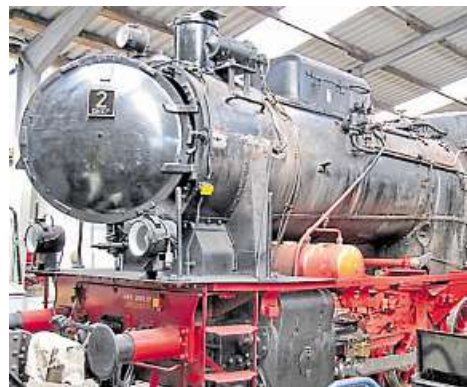
Der neue Schornstein sitzt jetzt auf der Rauchkammer von Lok Anna.
